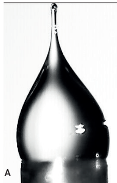
Obr. 4 A) Vysokorychlostní kamerou zaznamenaný počátek zvláknňovacího procesu při stejnosměrném elektrospinningu z jehlové (kapilární) elektrody, kdy je vytvářena jediná polymerní tryška. B) Stovky polymerních trysek vytvářených metodou střídavého zvláknňování.
