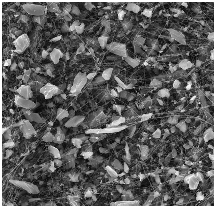
Obr. 7 Nanovláčkový vzorek s rozptýlenými částicemi aktivního uhlí v mezivláčkových prostorech
